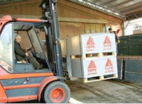
Resim 73 Yükleme yapılırken, en fazla ikişer palet olarak yükleme yapılmalıdır.
